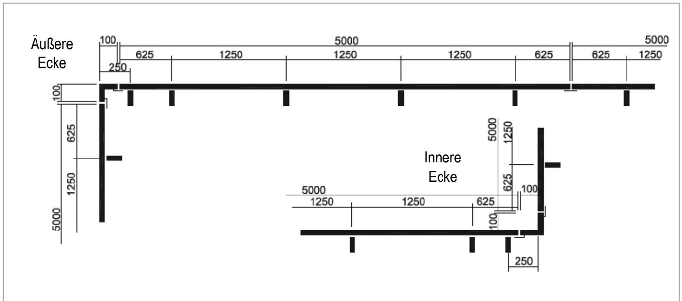
BREITE DER STOSSFUGE JE NACH PROFILLÄNGE UND EINBAUTEMPERATUR
