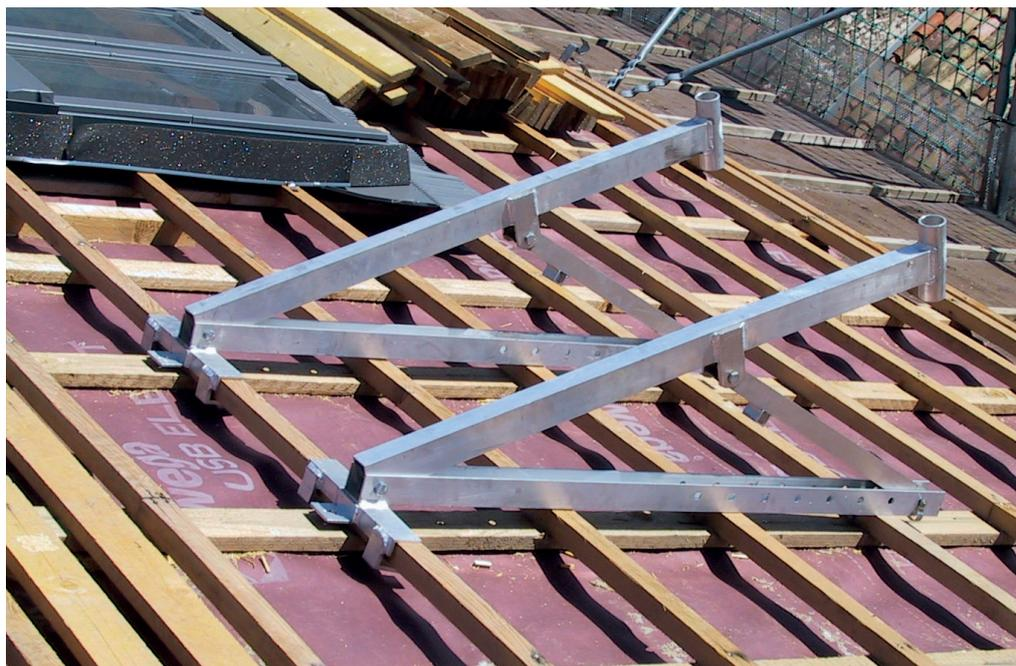
Der **Dachständer Alu** ist eines der wichtigsten Arbeitsmittel für den Zimmermann. Das vollständig aus Aluminium gefertigte Produkt zeichnet sich durch sein geringes Gewicht aus und bietet dank seiner Verstellbarkeit über ein Lochraster eine Auflagefläche von bis zu 1,10 m für Neigungen von 20° bis 60°. Er dient der Schaffung einer horizontalen Ebene auf dem Schrägdach für die Lagerung von Materialien wie Ziegeln, Dacheindeckungen, Holz und Werkzeugen.
