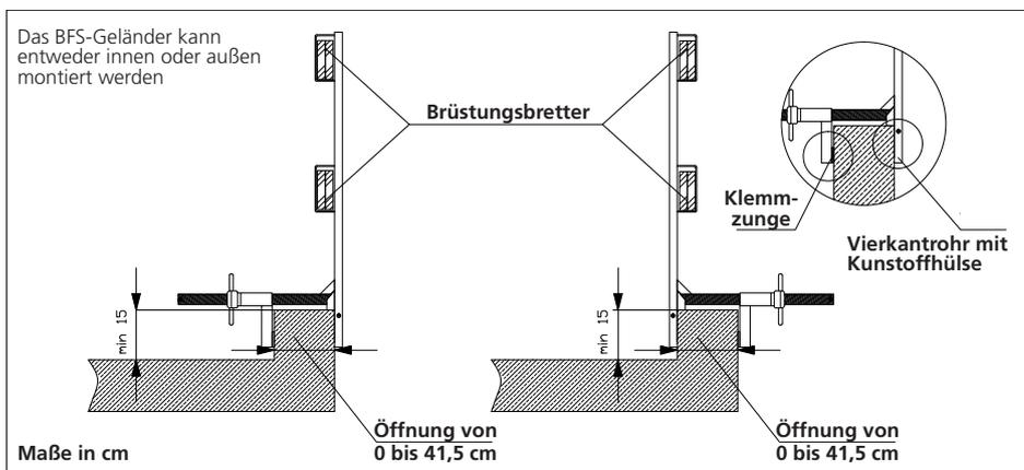
Die **BFS-Geländerzwinge** ist das ideale Produkt für die Sicherung von Flachdächern mit einer Brüstung von mehr als 15 cm. Dank einer speziellen Zunge und einer Einweg-Kunststoffhülse können auch vorgefertigte Wände gesichert werden, bei denen noch der Guss durchgeführt werden muss. Die Klemme hat eine maximale Öffnung von 41,5 cm. Die BFS-Geländerzwinge ist vollständig aus verzinktem Stahl gefertigt.
