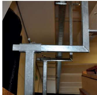
Das **Ortganggeländer** ist eine schnelle und einfache Absturzsicherung für die Montage und Demontage. Es besteht vollständig aus verzinktem Stahl und ist nach der europäischen Norm EN 13374 Klasse A zertifiziert.
