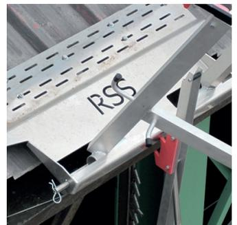
Das Geländer **Roof Safety System** ist ein innovatives Produkt im Bereich der kollektiven Schutzsysteme. Es besteht vollständig aus Aluminium und ist nach der europäischen Norm UNI EN 13374, Klasse C, zertifiziert, was die Verwendung auf Dächern mit einer Neigung von bis zu 60° ermöglicht. Es besteht aus einem 3 m langen Geländer, Konsolen und einem Bordbrett, so dass keine zusätzlichen Bretter erforderlich sind.
