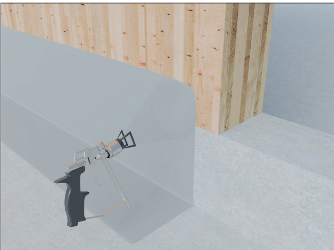
Wasser-, Luft- und Windabdichtung an der Bodenauflage und Bodenbefestigung von Holzwänden (X-Lam, Holzrahmen, Blockhaus)
