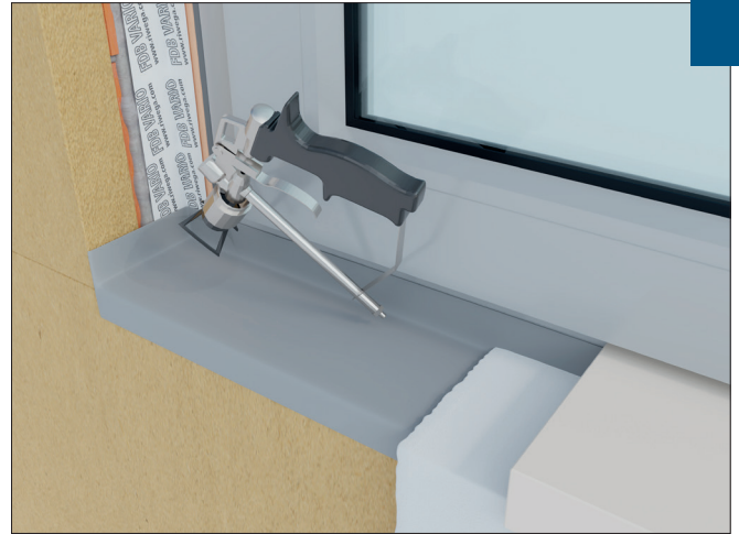
Abdichtungen unter dem Fensterbrett
