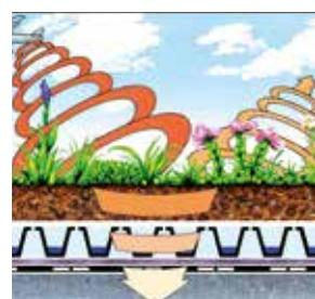
I tetti verdi riducono il rumore riflesso fino a 3dB e migliorano l'isolamento acustico fino a 8 dB. Questi vantaggi sono particolarmente utili per gli edifici situati ad esempio sotto un corridoio aereo o che ospitano locali con elevate fonti di rumore.
