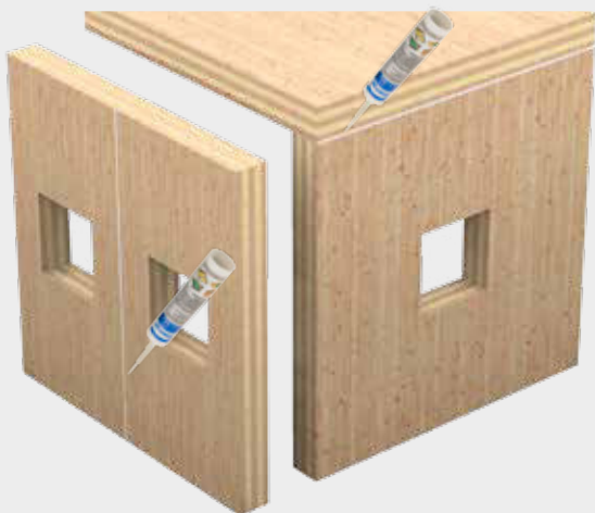
Sigillatura della giunzione tra due pareti in legno e tra pareti e solaio in legno
