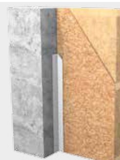
Sigillatura di una parete in legno a ridosso di una parete intonacabile
