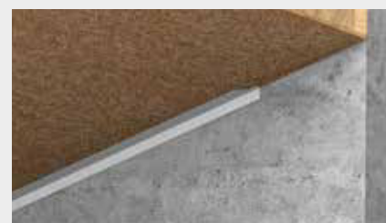
Sigillatura di un solaio in legno a ridosso di una parete intonacabile
