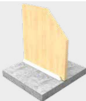
Sigillatura della base delle pareti in legno (sia telaio che X-Lam)
