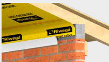
Sigillatura di uno schermo freno al vapore posato all'interno di un tetto a ridosso con l'attacco ad una parete intonacabile
